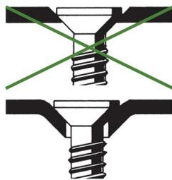
Die Schraubenaufnahmen haben eine spezielle Nut zur Verstärkung der Verbindungsfestigkeit.
