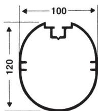
Verstärktes Aluminiumprofil - gerippt, oval 100/120 mm.
